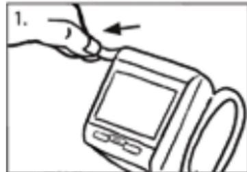
Vor der ersten Messung bitte den Batterie-Schutzstreifen entfernen.
