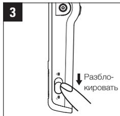
3 Разблокируйте прибор, сдвинув вниз блокировочную кнопку, расположенную сбоку.
