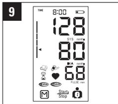
9 После измерения на дисплее появляются измеренные значения кровяного давления.
