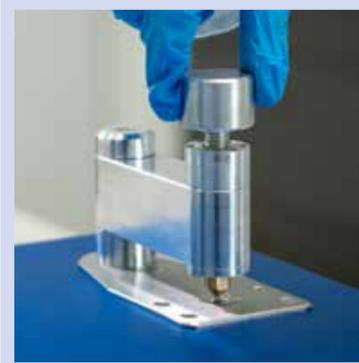
Bei Proben von Feststoffen oder Pulvern drücken Sie zusätzlich die Probe mit dem Andruckarm auf der Messfläche an.
