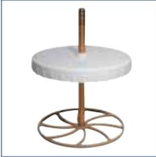
1. Das Mischwerkzeug durch die Öffnung des Mischdeckels führen.
