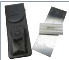
Um die Partikelgröße einer Suspensionsrezeptur genauer zu bestimmen, empfehlen wir die Überprüfung mit dem Grindometer (Best.-Nr. 026220). Partikelgrößen zwischen 0 und 100 µm können mit dem Grindometer gemessen und die Rezeptur dahingehend überprüft werden.
