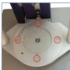
4. Beim Einsetzen in den fest montierten Aufnahmering des TOPITEC® Systems darauf achten, dass die Defekturdose richtig sitzt (siehe rote Kennzeichnung).
