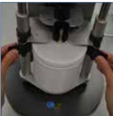
8. Zum Fixieren der Defektdose, den rechten und linken Verriegelungsbügel seitwärts, bzw. bei älteren TOPITEC® Modellen, nach hinten umlegen.
