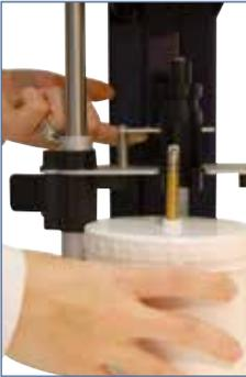
5. Der Niederhalter an der Verriegelungsbrücke nach oben ziehen und die Dose mit Mischwerkzeug in die Werkzeugwelleneinführungen „einführen“. Beim Einsetzen darauf achten, dass die Defektdose mit den 4 Standfüßen richtig im Aufnahmering sitzt.
