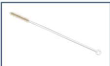
Rohrzylinderbürste zur einfachen und bequemen Reinigung des Gewindes im Abfüllkolben des Rezepturgefäßes, aus Naturborsten (Besatz 70 x 10 mm) und mit Kunststoff ummanteltem Draht.
