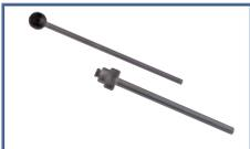
Für das Umfüllen in schmale Packmittel, z.B. Kosmetikspender. Passend für alle Rezepturgefäß-Größen (30 g, 50 g, 100 g und 200 g). Füllrohr aus Edelstahl mit Gewinde M9,  $\varnothing$  6 mm, mit Reinigungsstößel, mit Aufbewahrungsbox.
