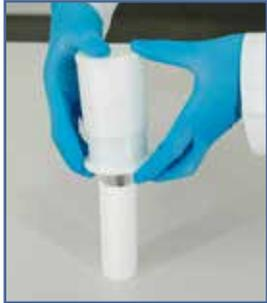
**8.b** Das Rezepturgefäß wird so positioniert (über Kopf), dass das Füllrohr möglichst tief in das Gefäß reinragt, im besten Fall bis knapp über den Gefäßboden.
