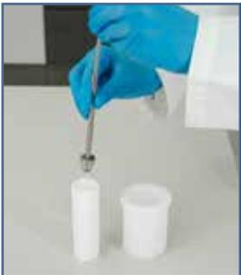
**8.d** Die im Füllrohr verbleibende Menge (ca. 1 g) kann durch den Stößel aus dem Rohr herausgedrückt und in den Spender eingefüllt werden.
