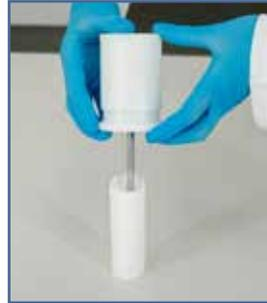
**8.c** Durch gleichzeitiges Gegen drücken des Mischgefäßes und des Füllkolbens wird die angefertigte Rezeptur eingefüllt. Beim Abfüllen das Füllrohr gleichmäßig und langsam nach oben ziehen, dadurch wird eine luftarme und somit gleichmäßige Füllung gewährleistet.
