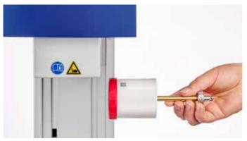
Abb. 18: Kamera scannt Matrixcode vom Krukenkörper
