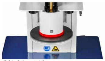
Abb. 8: Korrekt eingespannte Kruke
