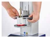
Abb. 27: Verriegelung der Brücke
