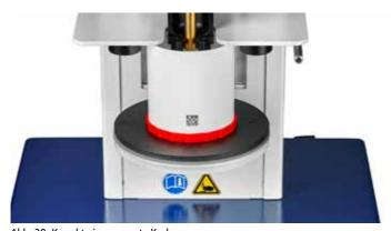
Abb. 28: Korrekt eingespannte Kruke
