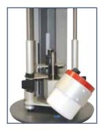
3. Der Haltering wird in den Anschlussstutzen des Getriebeblockes gesteckt und solange gedreht (links oder rechts) bis das Kugellager des Halteringes im Getriebeblock einrastet. Überzeugen Sie sich auf jeden Fall vom kraftschlüssigen Sitz des Halteringes im Getriebeblock.
