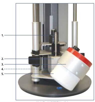
Abb. 1-1 Übersicht TOPITEC® Pulver-Mischsystem
