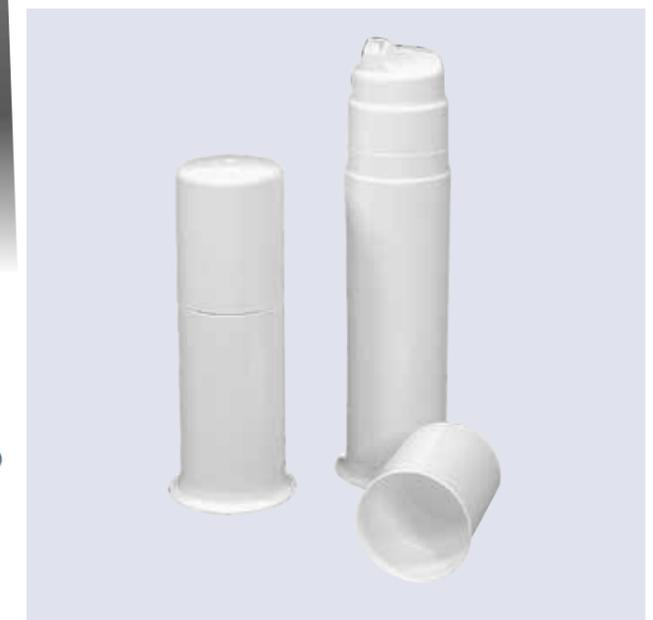
Die bewährten **Mega-Spender** in weiß. Sie liegen gut in der Hand und eignen sich zum Befüllen mit dünnflüssigen Gelen bis hin zu viskosen Cremes. Beim Herunterdrücken des Dosierkopfes wird ein Vakuum erzeugt, und ein spezielles Ventilsystem verhindert den Kontakt des Inhaltes mit der Umgebungsluft.
