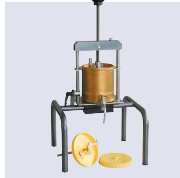
Das TOPITEC® Defektur-System eignet sich für die Herstellung größerer Rezepturansätze bis zu 1.000 ml. Die im Lieferumfang beinhaltete Abfüllvorrichtung wurde so konzipiert, dass sie über gängige Rezepturwaagen positioniert werden kann. Der Abfüllhahn am Herstellungsgefäß gewährleistet ein bequemes Abfüllen bzw. dosieren der Rezepturen in kleinere Gefäße und direkt in Tuben.
