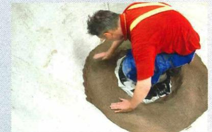
Formenbau Füllen der Verschaltungen mit Gips, KONSCHOLKE/CERTEC Mogendorf,
